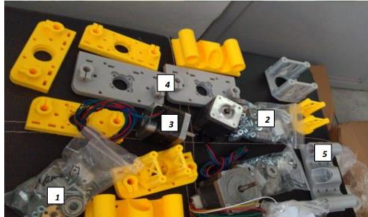
Figura 20. componentes mecánicos rodamientos (1), tornillería (2), motores (3), soportes (4), carro guía (5).
