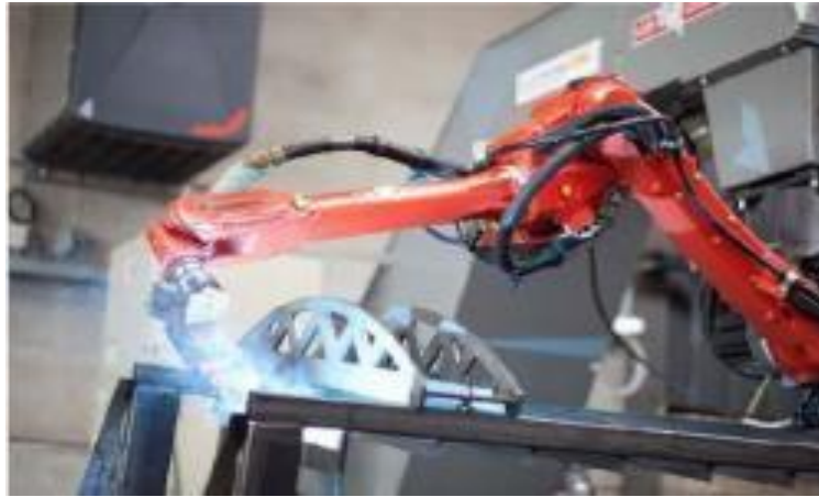
Figura 3. Se ilustra un brazo robótico industrial en el área de soldadura para un proceso en serie. 7
