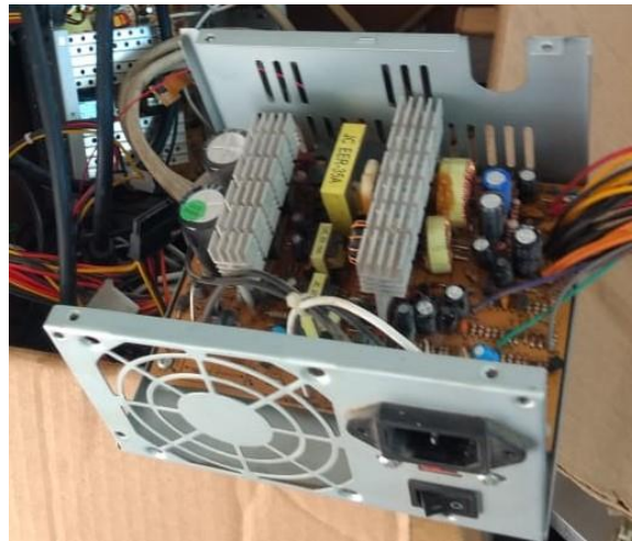
Figura 24. Fuente de poder ATX utilizada para la alimentación eléctrica del Robot Cartesiano.
