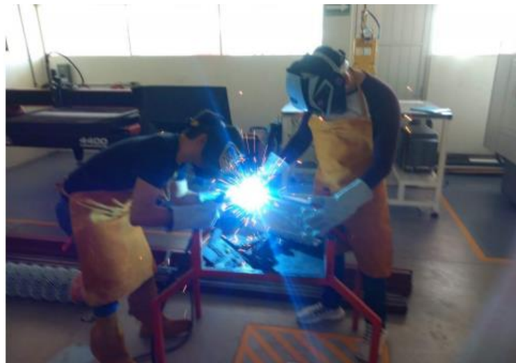
Figura 21. Se muestran los procesos de soldadura del tipo acero 20 Kg 1/8 Verde 6013 Infra Miller.
