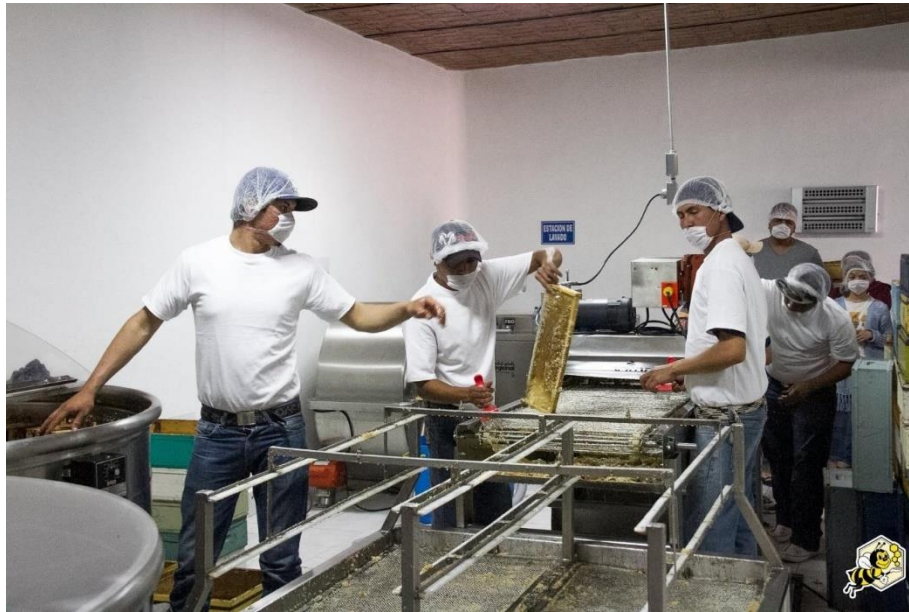
Figura 13. Proceso manual del traslado de los bastidores para el llenado de la centrifugadora. 22
