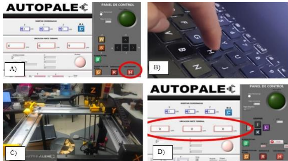
Figura 50. Se muestra A) el panel maestro, indicador “H”, B) el operador presionando la tecla “H”, C) El autómat a yendo a su punto inicial y D) los indicadores de posición para cada eje.
